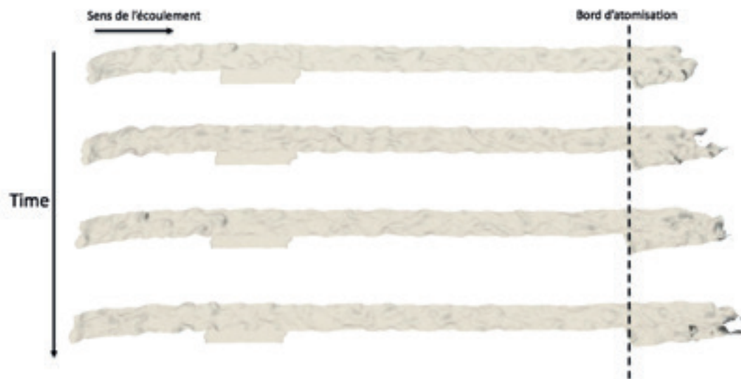
Figure 10 : Snapshots du mouvement de l'interface liquide/gaz - vue de côté.
